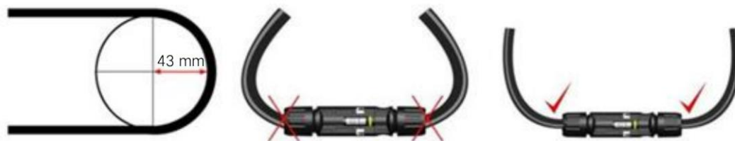
图 8 电缆的最小弯曲半径
